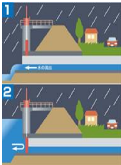
図 2 排水樋門・樋管の仕組み
