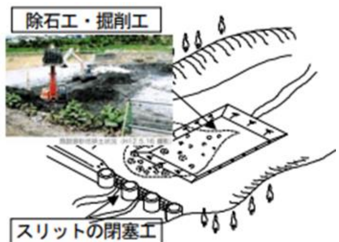
図 10.3 設砂防設備の対策工イメージ図
