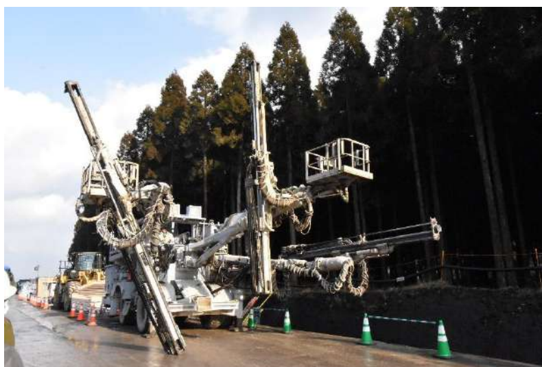
図 3.1.11 実際に動かしていただいたドリルジャンボ
