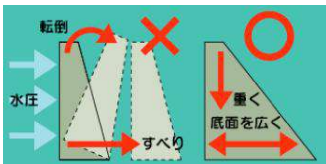
図 11.4 重力式ダム仕組み
