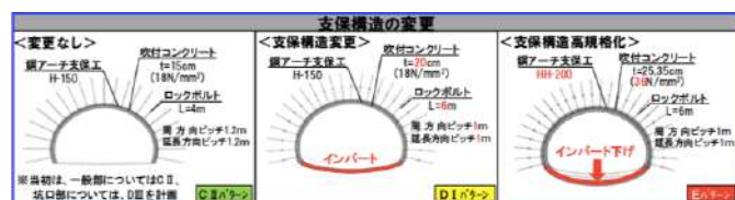
図 4.4 支保構造変更概要図
