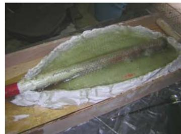
紙粘土型枠の上でグラスファイバー配置と樹脂含浸を4層繰返す
