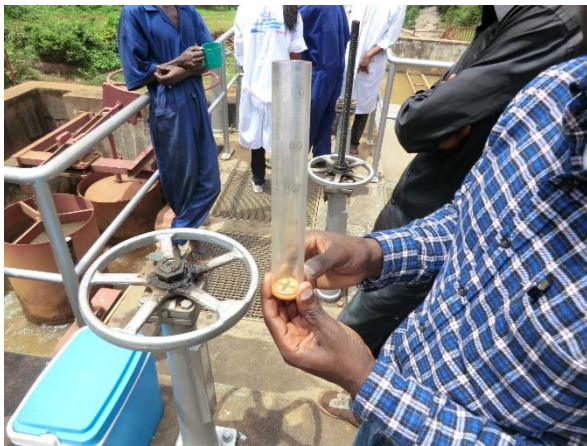
取水施設では透明度を計測していました。これが 0.5cm で筒底の×が見えないときには浄水場への送水をとめているとのこと。
