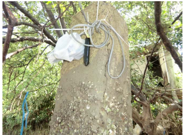
しかし, 想定以上まで潮位が上がってしまい, データロガーごと水に没してしまいました. 次回からは注意します.
