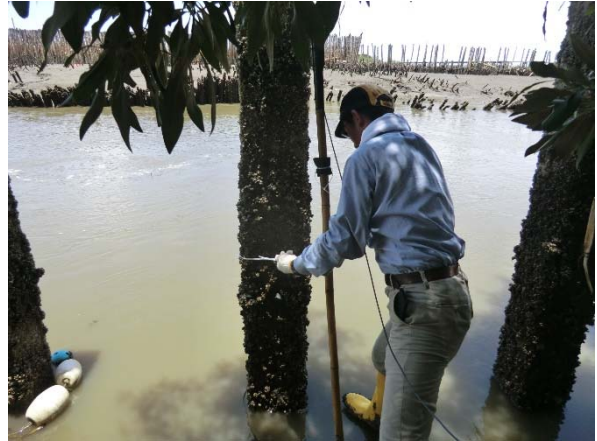
今回は, Bamboo site 脇にある運河にて潮位, 流速計測も試みました.
