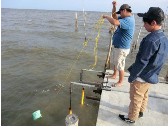
Bamboo siteにて海水サンプルの取得。水質計のデータと合わせてデータを取得していきます。
