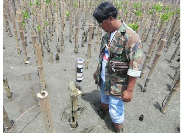
密に竹が設置されている箇所での波浪測定。
