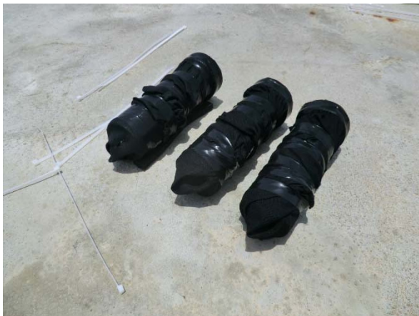
Bamboo siteに設置する波浪計は、盗難防止のため黒い布で巻き、遠目からはわかりにくくしています。
